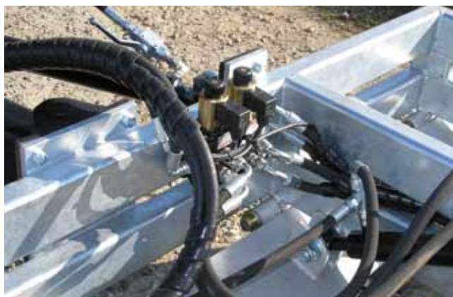
Kontrolcenter til betjening af sideregulering, kip og hjul, hydr. materialekasse og hydr. skær.
