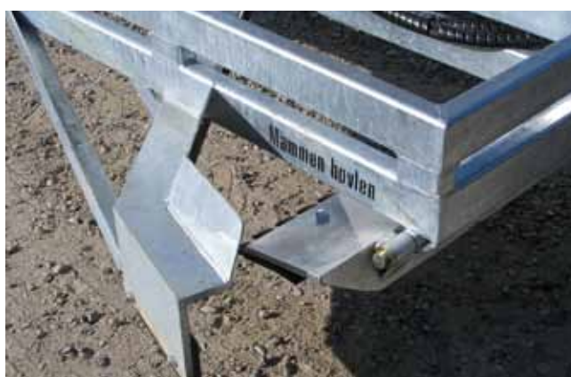
Kraftig dobbelt ramme af profilrør sikrer kraft og styrke. Skærkanter og hydr. skær (ekstraudstyr).
